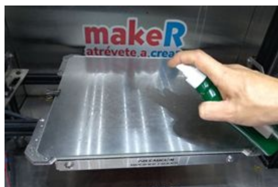
Figura 37. Aplique laca de manera uniforme sobre la superficie
