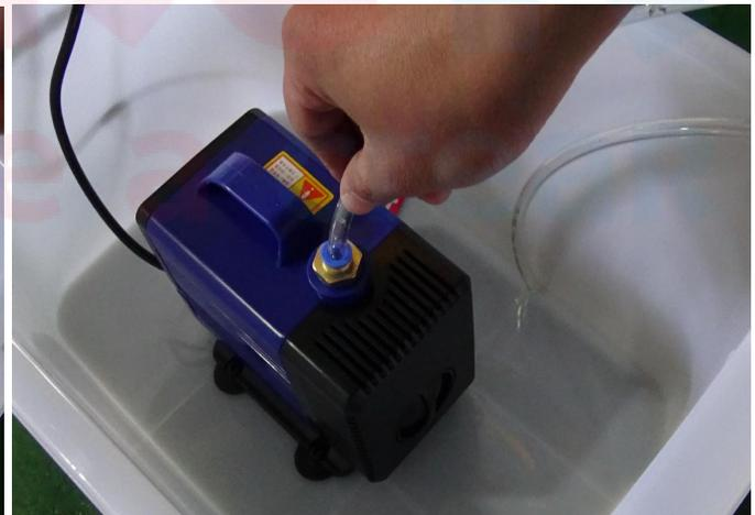
Seguidamente, llene el recipiente con agua, al nivel suficiente para que la bomba quede completamente sumergida, al menos el agua debe estar unos 3-5cm por encima de la bomba.
