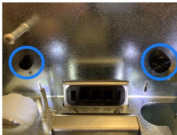
*Figura 11: Tornillos de mariposa de la interfaz de usuario para ajustar la posición de altura de los fotorresistores.*
