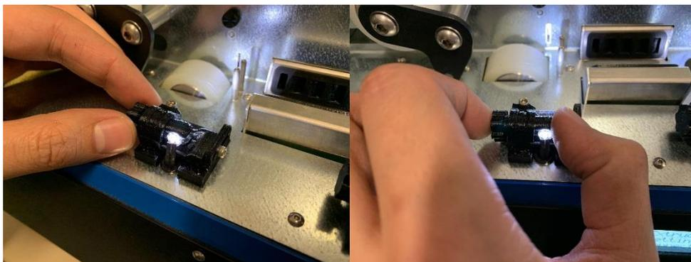
*Figura 12: Cómo sujetar el eje de la guía de luz para ajustar el ángulo del LED.*
